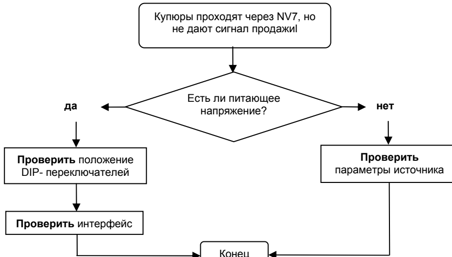
Рисунок 15 – Купюра проходит через NV7, но не выдает сигнал продажи
